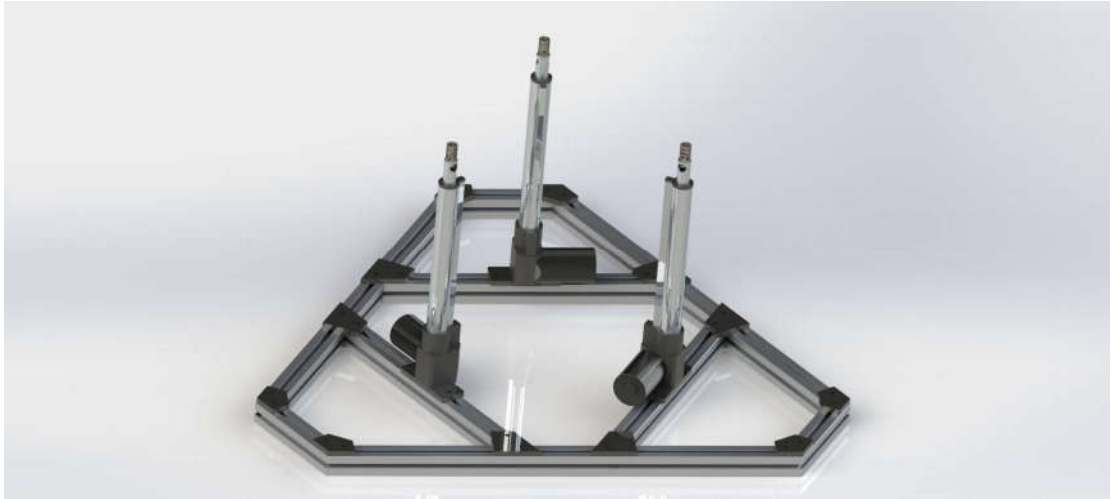
Hình 2.8. Đế cố định và các động cơ tuyến tính
