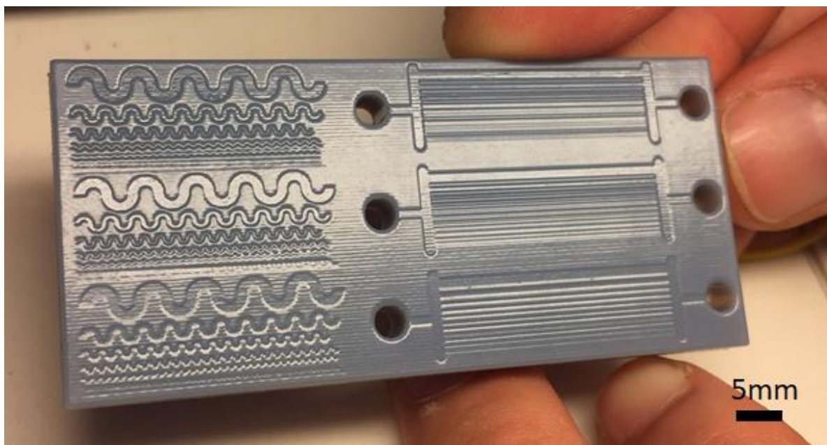
Hình 3.8: Hình ảnh kênh vi lỏng chế tạo bằng công nghệ tạo mẫu nhanh - 3D printing.
