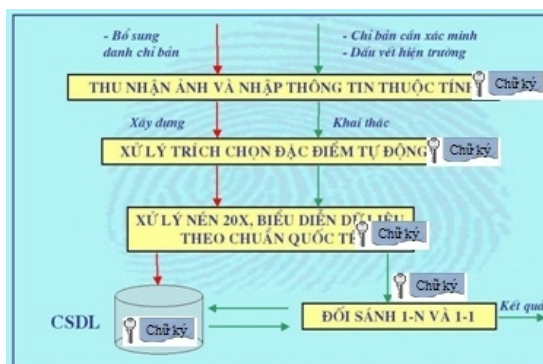
Hình 4.6: Mô hình thử nghiệm hệ C@FRIS có tích hợp giải pháp BioPKI
