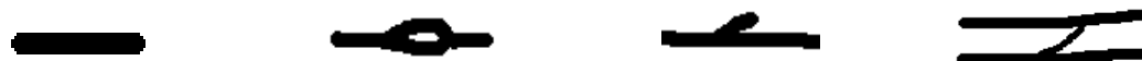
(a) Đoạn vân ngắn dạng đảo (b) Đoạn vân hình mắt (c) Nhánh móc (d) Đoạn cầu nối
