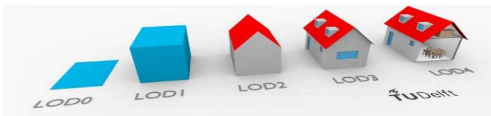
Hình 1.4. Các cấp độ chi tiết từ LoD0, LoD1, LoD2, LoD3 và LoD4 của đối tượng nhà.
