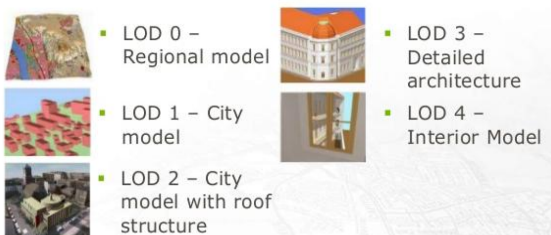
Hình 1.1. Cấp độ chi tiết LoD đối với các đối tượng nhà, khối nhà
