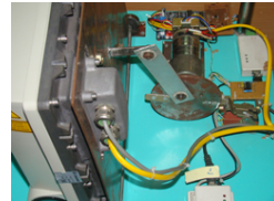
Hình 2.10b Cơ cấu truyền động quay và mô-tơ servo.
