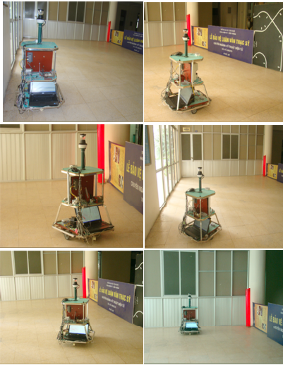
Hình 3.11. Ước lượng góc nhìn \gamma_k từ robot đến vật mốc màu đỏ (x_m, y_m) bằng phép đo odometry và cảm biến ảnh toàn phương.
