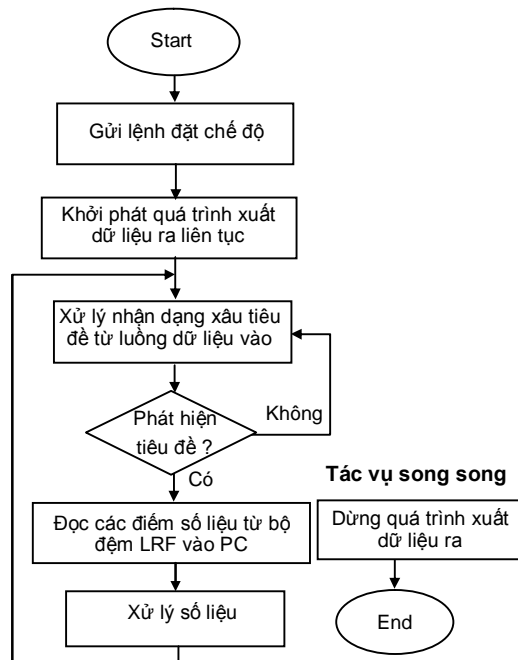
Hình 2.9 Lưu đồ chương trình thu và xử lý số liệu.
