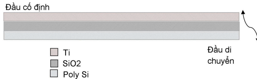
Hình 1.7 Một thanh chấp hành vi gấp nhiệt điện 3 lớp [46]
