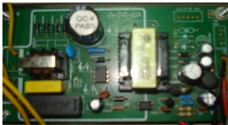
Hình 2.8: Mạch điện cấp dòng nuôi ổn định cho các mô-đun laser bơm
