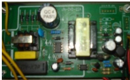
Hình 2.4: Mạch điện cấp dòng nuôi ổn định cho các mô-đun laser bơm
