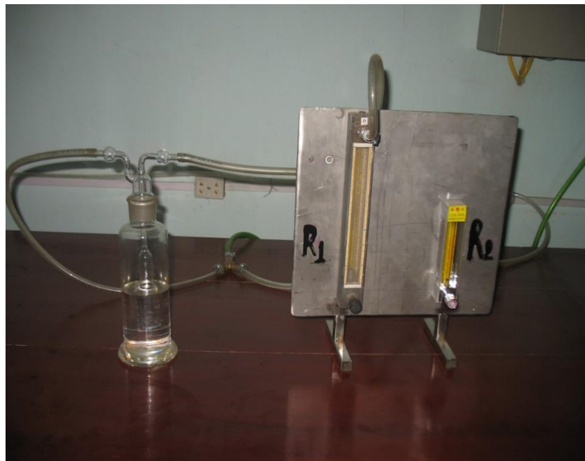
Hình 2.4. Bình chứa chất mang carbon (CMC) và các lưu lượng kế dùng để kiểm soát lưu lượng carbon CMC và Ar.
