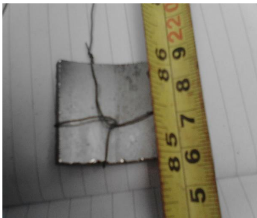
Hình 3.1. Kích thước và cách treo tấm đế bằng thạch anh để nhận màng mỏng PG có cấu trúc nano
