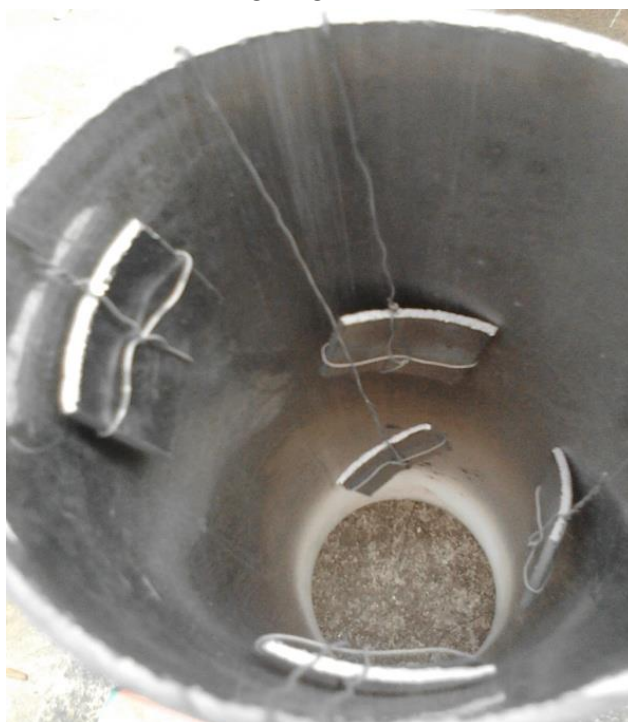
Hình 3.4. Các mẫu PG bố trí trong bình phản ứng bằng thạch anh ở nhiệt độ 950^{\circ}\text{C} . Các tấm đế thạch anh đặt trong ống thạch anh đã được CVD để nhận PG.
