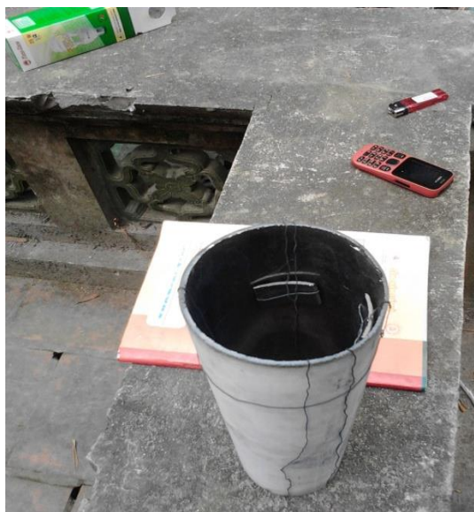
Hình 3.2. Cách bố trí các tấm thạch anh trong ống thạch anh. PG được kết tinh lên các tấm đế đó và lên cả thành ống thạch anh.
