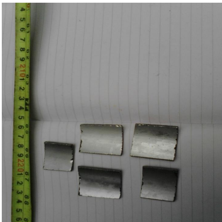
Hình 3.9. Các mẫu PG trên các đế thạch anh được CVD ở 900°C
