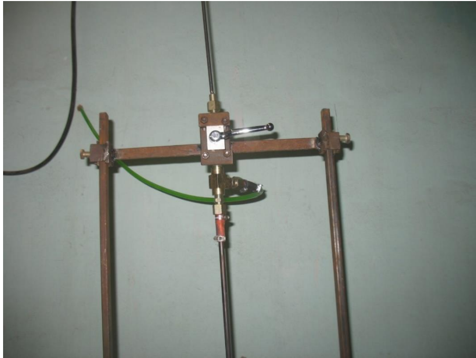
Hình 2.3b. Thiết bị CVD của Viện IHT. Đồ gá dùng để giữ thanh thép không gỉ thông ống dẫn khí khi trên miệng ống bị PG kết tinh làm bịt miệng ống không cho khí đi vào buồng CVD.
