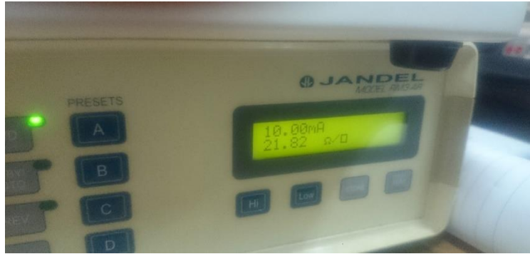
Hình 3.20. Chỉ số điện trở vuông của các mẫu PG1,2,3 được đo bằng máy JANDEL AM3-AR tại Phòng thí nghiệm nano của trường Đại học Công nghệ - ĐHQGHN với các dòng đo khác nhau
