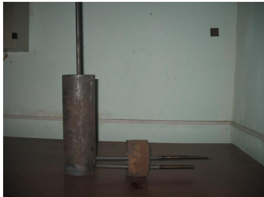
Hình 2.6. Buồng CVD (chi tiết bên trái), nắp dưới có ống bảo vệ can nhiệt (chi tiết bên phải).
