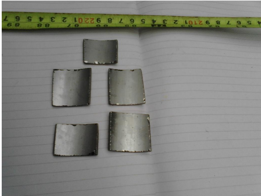
Hình 3.7. Các mẫu PG trên các đế thạch anh được CVD ở 1000^{\circ}\text{C}
