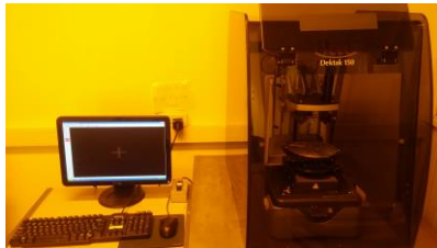
Hình 2-18: Hệ đo độ dày màng mỏng Alpha-step
