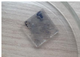
Hình 3.7: Mẫu nhôm bốc bay được kẽm hóa bề mặt trong thời gian 15 giây
