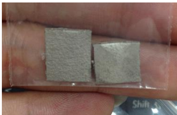
Hình 3.3: Mẫu nhôm mạ không điện cực khi được thêm phụ gia.
