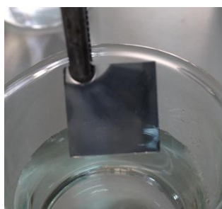
Hình 3.12: Mẫu nhôm phún xạ sau khi kẽm hóa bề mặt trong thời gian 5 giây
