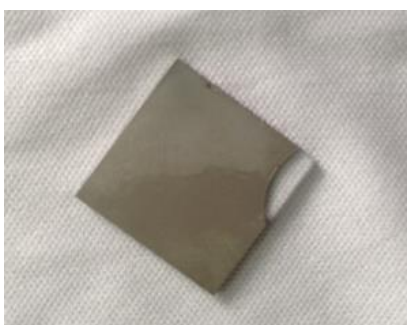
Hình 3.13: Bề mặt mẫu nhôm phún xạ sau khi mạ nickel không điện cực
