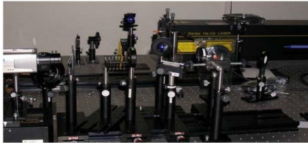
Hình 2.4. Hệ đo huỳnh quang phân giải cao dùng laser He-Ne.
