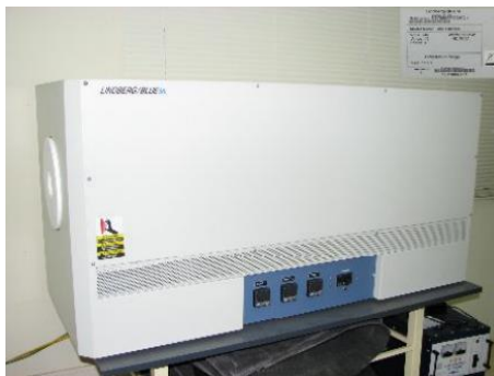
Hình 3.1. Hệ lò được dùng để ủ tiếp xúc cho phiến silic bốc bay nhôm
