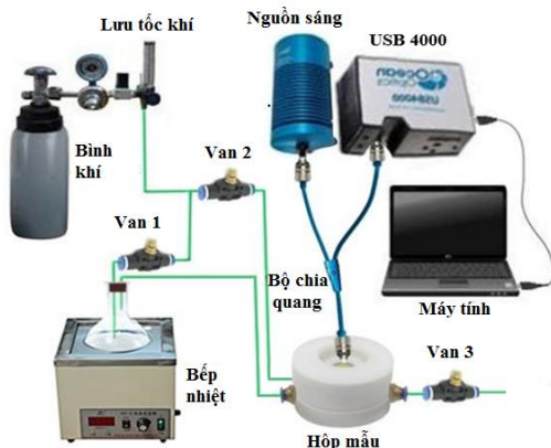
Hình 3.10. Sơ đồ hệ đo nồng độ dung môi bằng cảm biến pha hơi dùng hiệu ứng nhiệt độ và áp suất hơi riêng phần.
