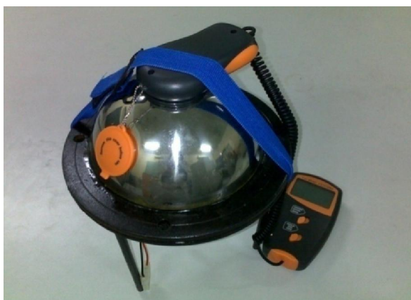
Hình 2. 25. Hệ khảo sát độ ổn định WLED sử dụng quả cầu tích phân và máy đo độ rọi LX1010BS
