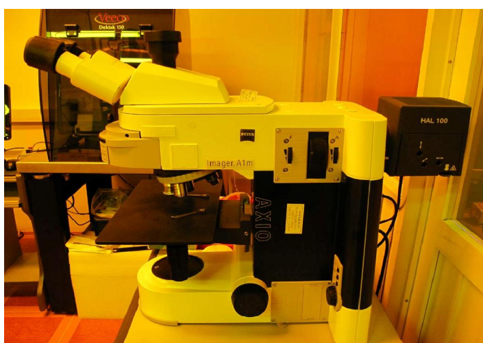
Hình 2. 19. Kính hiển vi quang học AX10 với độ phóng đại 1000 lần
