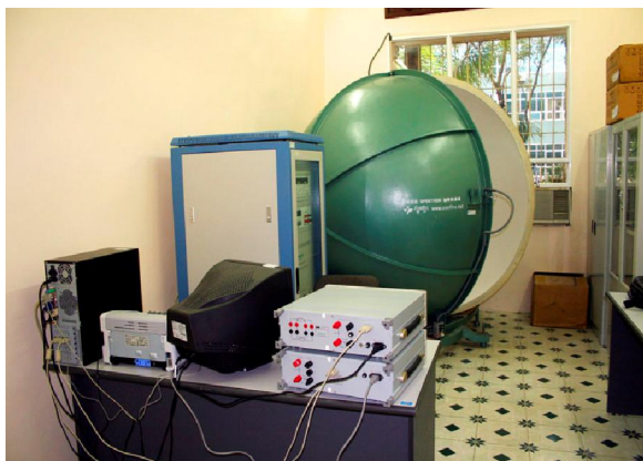
Hình 2. 24. Hệ thiết bị đo phổ kế đo màu quang (Spectrophotometer - PMS50 System).
