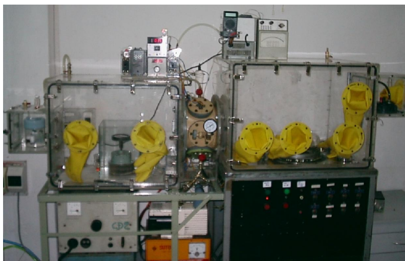
Hình 2. 2. Hệ chế tạo OLED tích hợp dựa trên Glovebox và hệ bốc bay nhiệt.
