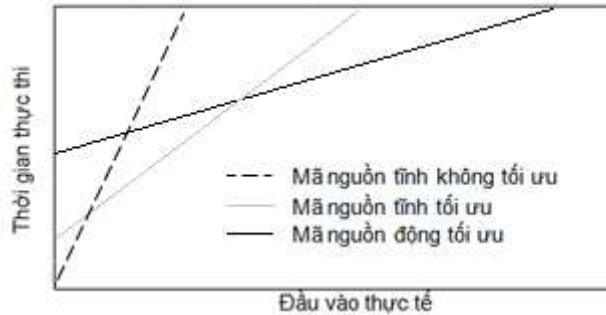
Hình 4.1: So sánh giữa tối ưu tĩnh và tối ưu động mã nguồn đã chuyên biệt hóa
