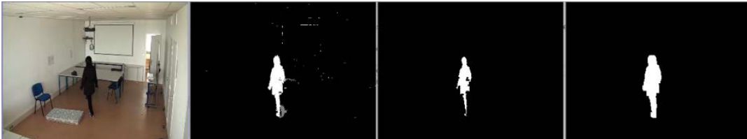
Hình 3.9. Một ví dụ phân tách vùng chuyển động. Từ trái qua phải, ảnh đầu tiên là ảnh đầu vào từ chuỗi video; ảnh thứ 2 là kết quả của giải thuật trừ nền GMM; ảnh thứ 3 thể hiện kết quả loại bỏ các đốm nhỏ bằng thực hiện phép co; ảnh cuối cùng sau khi thực hiện phép giãn nở, các đốm lớn đã được kết nối và thể hiện tốt hình dạng cơ thể
