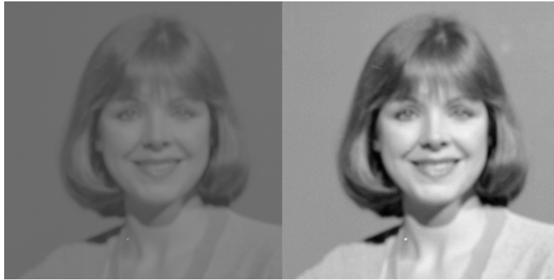
Hình 2.6. Ví dụ minh họa điều chỉnh độ tương phản: Ảnh bên trái là ảnh ban đầu; ảnh bên phải là ảnh kết quả thu được sau điều chỉnh tương phản
