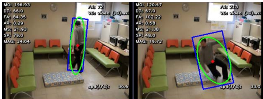
Hình 3.15. Minh họa sự thay đổi hình dạng cơ thể khi ngã: Ảnh bên trái, AR = 0.29 khi đi lại thông thường; ảnh bên phải, AR = 0.58 khi ngã
