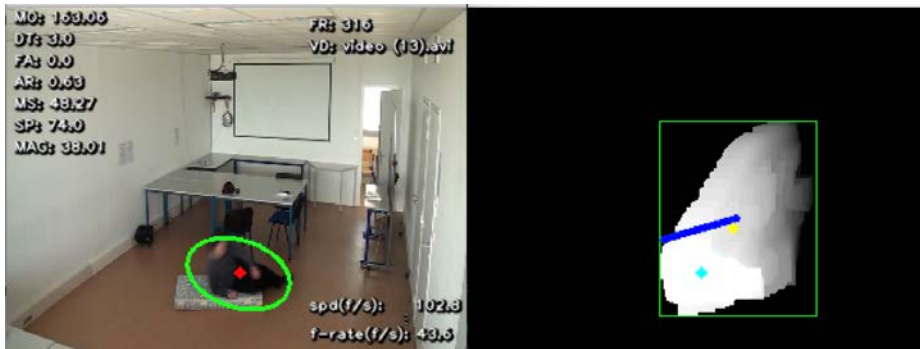
Hình 3.10. Ví dụ minh họa ảnh MHI: Ảnh bên trái là khung hình trong chuỗi video; ảnh bên phải là ảnh kết quả thu được từ giải thuật MHI
