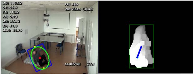
Hình 3.13. Ví dụ cho ước lượng độ lớn chuyển động: Ảnh bên trái là khung hình trích ra từ chuỗi video; Ảnh bên phải là MHI. Khi ngã, M_{rate} = 61\% , magn=28 , độ chuyển động của trọng tâm = 37
