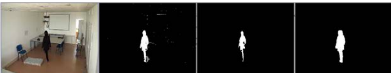
Hình 3.9. Một ví dụ phân tách vùng chuyển động. Từ trái qua phải, ảnh đầu tiên là ảnh đầu vào từ chuỗi video; ảnh thứ 2 là kết quả của giải thuật trừ nền GMM; ảnh thứ 3 thể hiện kết quả loại bỏ các đốm nhỏ bằng thực hiện phép co; ảnh cuối cùng sau khi thực hiện phép giãn nở, các đốm lớn đã được kết nối và thể hiện tốt hình dạng cơ thể
