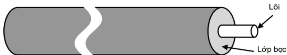
Hình 1.4. Cấu trúc cơ bản của sợi quang
