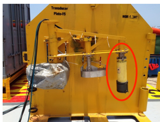
Hình 2.13 - Bộ thu phát Sonardyne 8024 Wideband gắn trên tàu khảo sát
