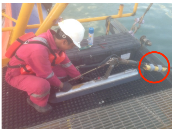
Hình 2.14 - Bộ phát đáp Sonardyne Coastal gắn trên cá đo quét ngang âm bề mặt EdgeTech 4200MP
