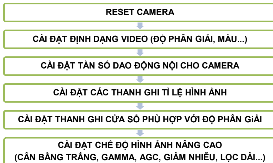
Hình 2.5: Lưu đồ cấu hình chế độ hoạt động của Camera OV7670
