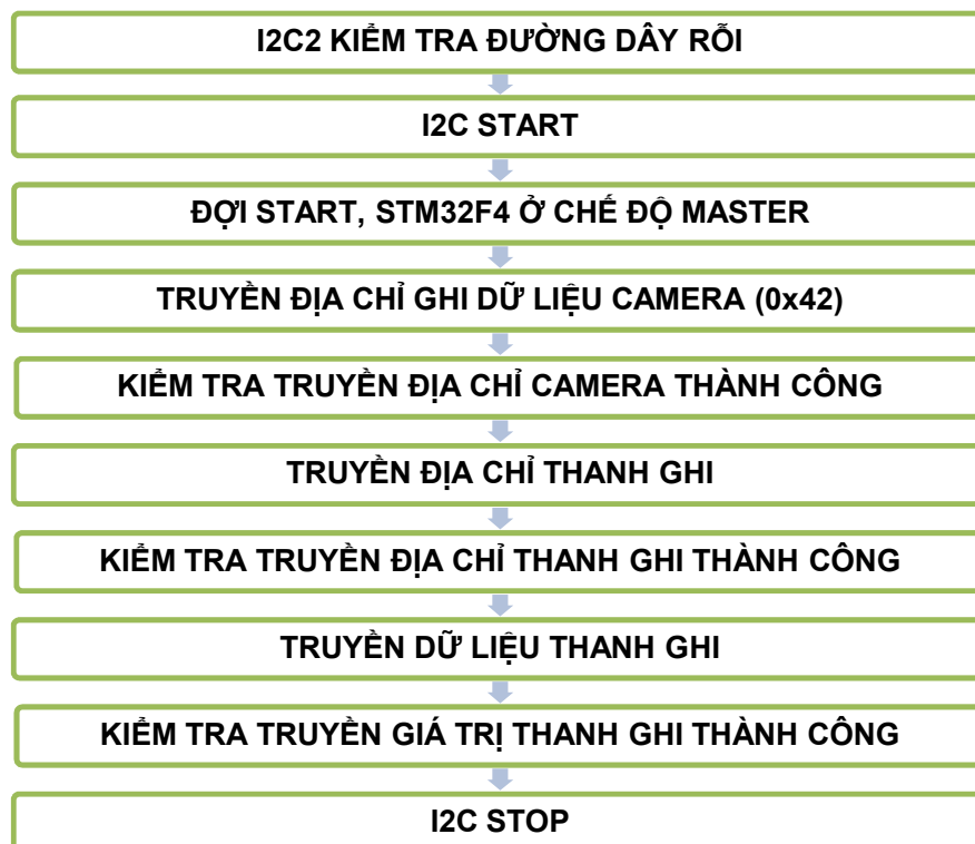
Hình 2.2: Lưu đồ thuật toán ghi dữ liệu thanh ghi camera OV7670
