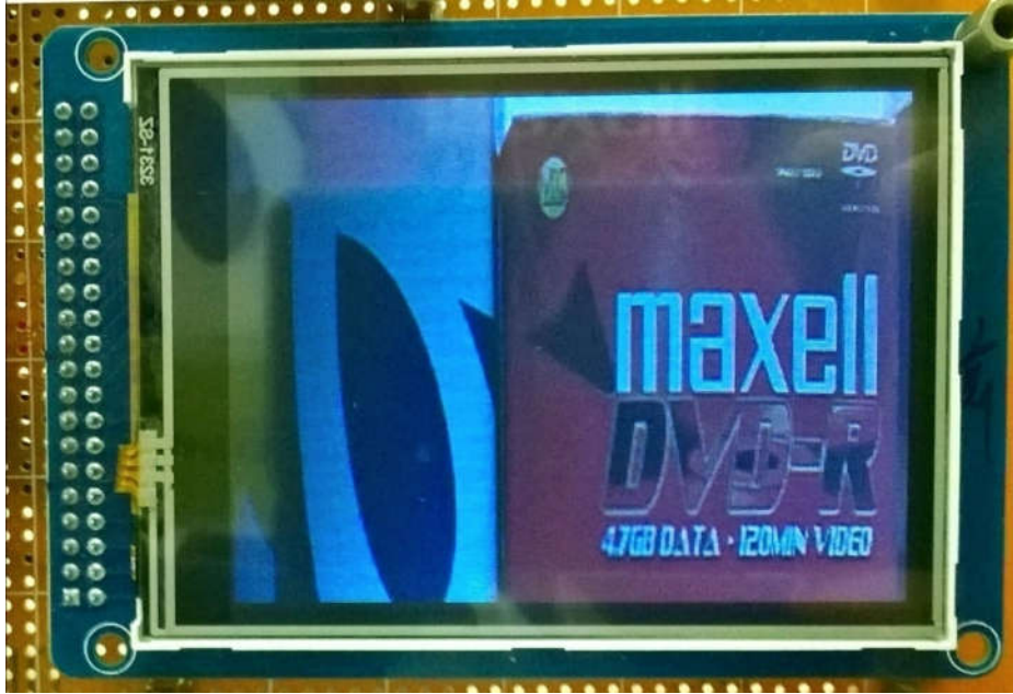
Hình 3.10: Hiển thị ảnh màu RGB lên màn hình LCD 3,2”
