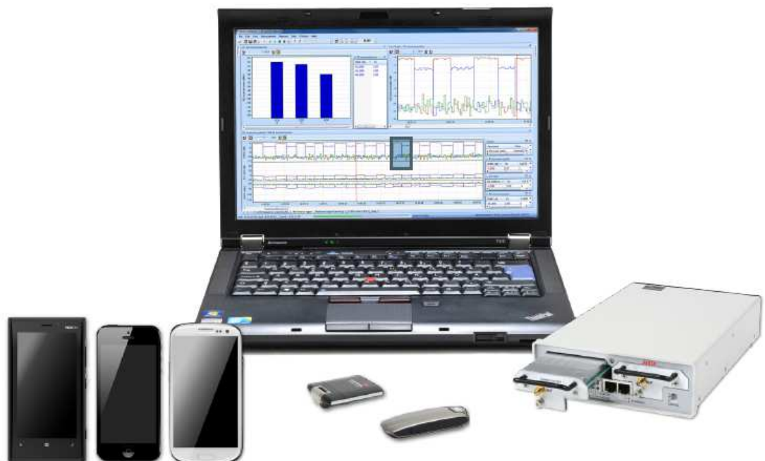
Hình 2 - 3: Bộ công cụ đo kiểm và đánh giá chất lượng dịch vụ 4G LTE
