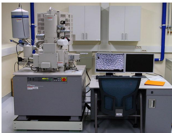
Hình 2. 5. Thiết bị FE-SEM Hitachi - S4800.
