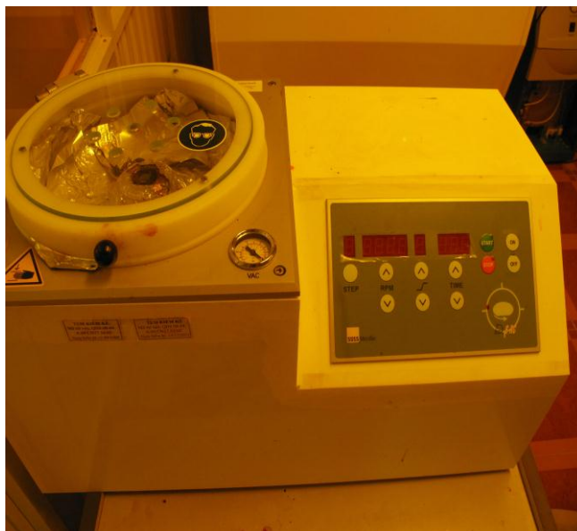
Hình 2. 2. Thiết bị spin-coating WS-400B-6NPP, Laurell (Anh).
