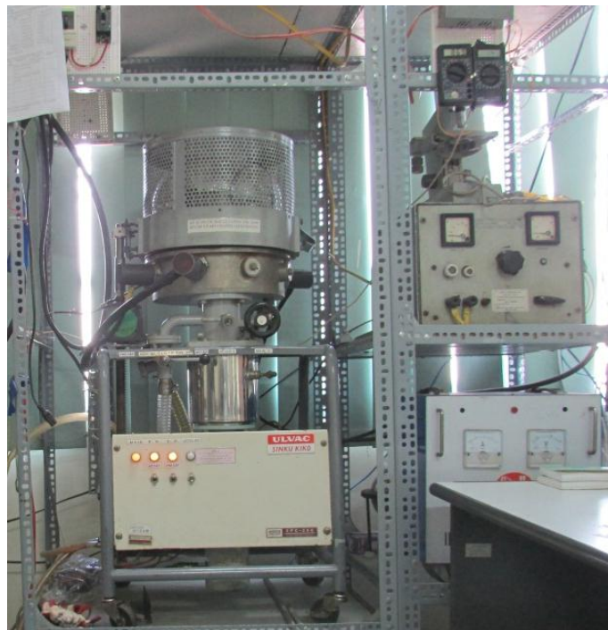
Hình 2. 9. Thiết bị bốc bay nhiệt chân không ULVAC-Sinku kiko.
